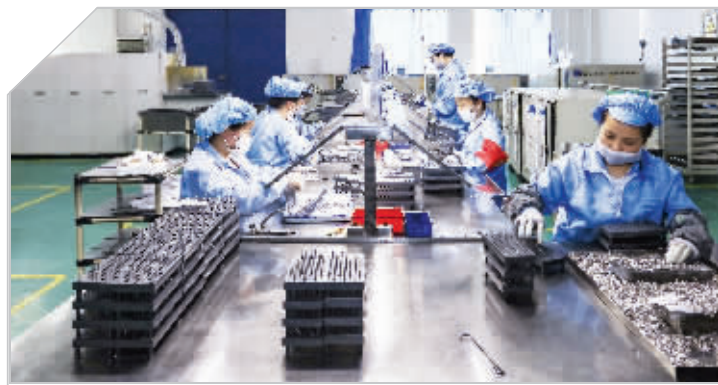
初级生产线采用人工手工装模,耗时多,效率低。
