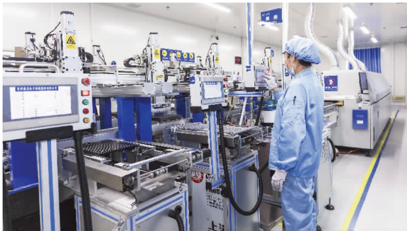
智能化生产线实现机器一体化、自动化装模,可自动区分正负极,提高了效率和优品率。
