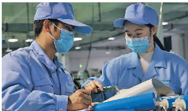
沃顿科技工人在抽检家用膜系列产品的膜厚度。
