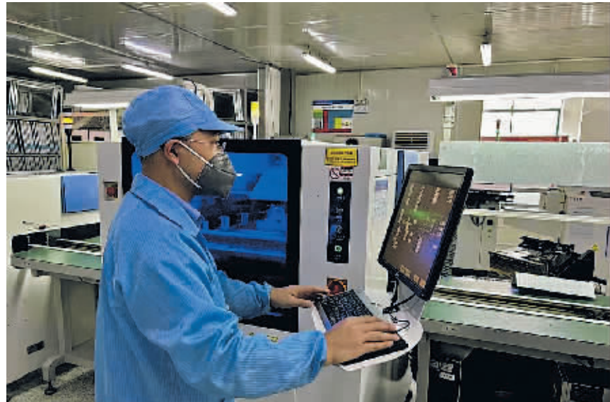
工作人员在仪表生产车间自动化SMT无铅生产线操作作业。
