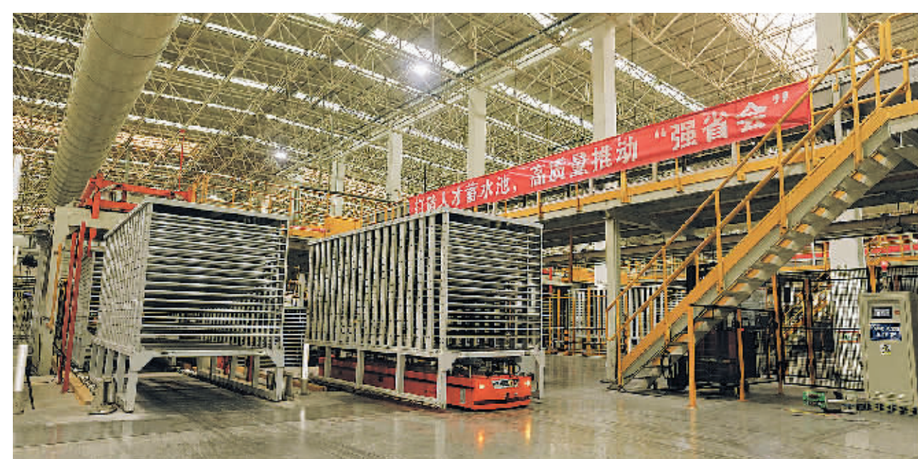
贵州轮胎卧式物流小车正在运送生产材料。 贵阳日报融媒体中心记者 梁超 摄
