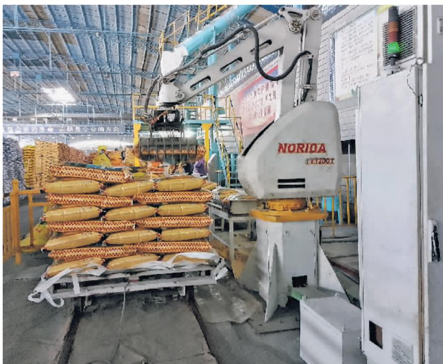
在西洋实业生产车间,机械手臂将复合肥产品码垛。
