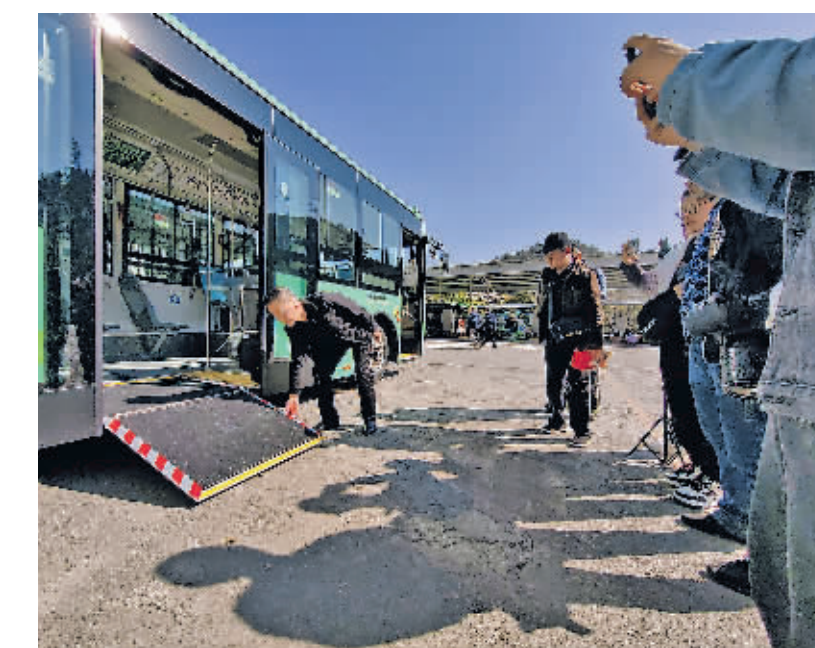
贵阳公交工作人员演示新能源公交车的可提拉式上下车踏板。
