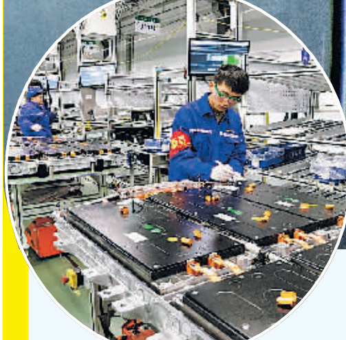
▲在上汽时代动力电池系统有限公司车间,工人在安装新能源汽车动力电池系统(2023年2月16日报)。
