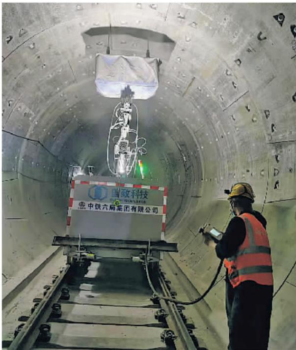
国致科技研发的隧道内壁打桩机器人在作业。
